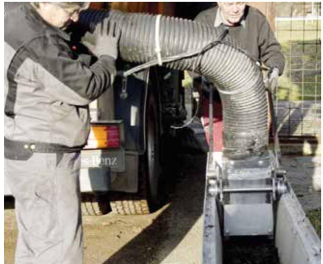
3. Sustitución del sustrato de filtro evacuado
