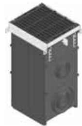
Įtekėjimo dėžė su juostinėmis kaliojo ketaus grotelėmis, apkrovos klasė E 600
